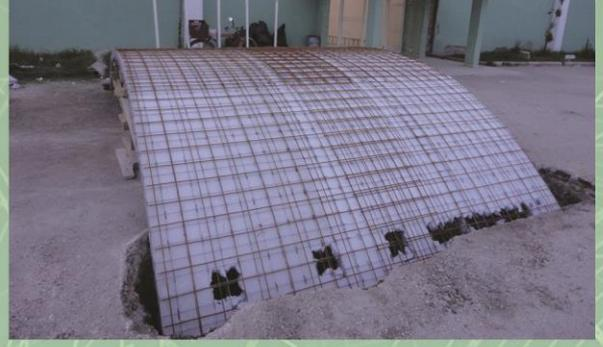
Zenon Panel, 6 mm. çapında hasır çelik donatı ile takviye edilmiş ve üzerine 10 cm. kalınlığında C30 beton dökülmüştür. 16 ton zati hareketli yük ile beraber 39 tonluk çizgi halinde uygulanan vibrasyonlu absorbe eden sünek sistem üstün performans göstermiştir. Video görüntüsü için internet sitemizi ziyaret ediniz.
