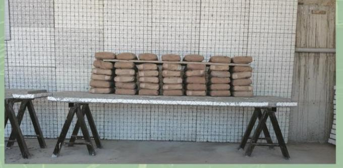
4m açıklıkta Zenon Paneli 2 kg/m<sup>2</sup> ilave donatı konulup, 9cm kalınlığında C30 beton dökülüp ve alttan 3cm siva yapılan döşeme üzerine 1,3 ton/m<sup>2</sup> ye kadar yüklemeler yapılmış ve Zenon Panel döşemenin yüksek performansı gözlemlenmiştir.
